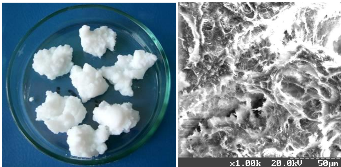
Рис. 1. Композитний хітозан-гідроксиапатитний матеріал для заміщення кісткових дефектів: зовнішній вигляд (ліворуч) та електронна мікроскопія (праворуч)
